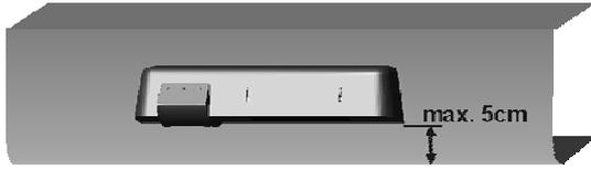
Monte el detector a una altura máxima de 5 cm. desde la base del aparato operador.
