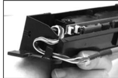
Para evitar infiltraciones de agua, coloque el cable tal como se indica en la foto.
