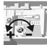
Para desplazar la barrera hacia la puerta, gire el tornillo en el sentido de las agujas de un reloj. Para aumentar la distancia entre la barrera y la puerta, gire el tornillo en el sentido contrario.
